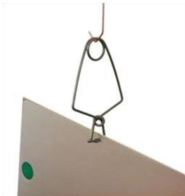
Diese Klammern sind optimal für die Aufhängung von Profilen oder Blechtafeln geeignet, die keine Aufhängemöglichkeiten wie z.B. Bohrungen haben. Durch ihre spezielle Klemmung hinterlässt diese Klammer nur eine minimale Aufhängespur.
